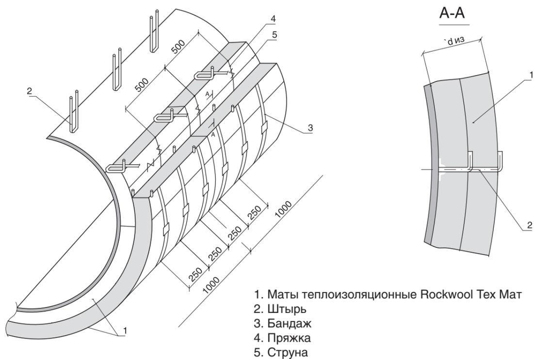
Рисунок 2.2.10. Изоляция горизонтальных аппаратов теплоизоляционными матами Rockwool Tex Mat в два слоя с креплением штырями
