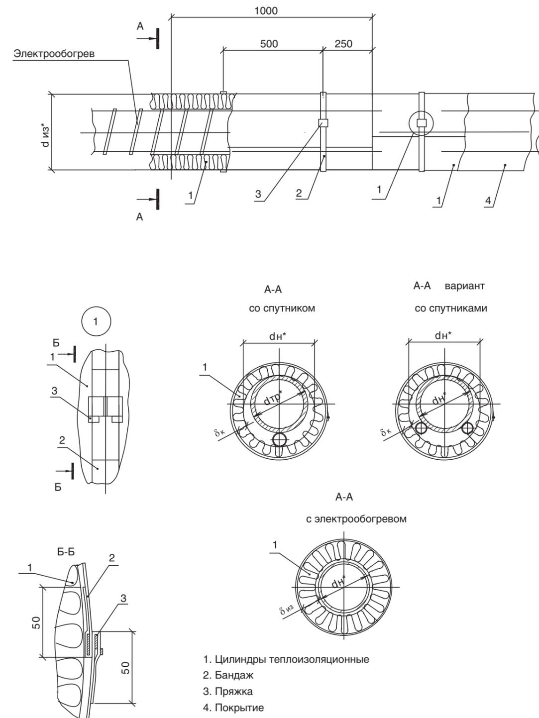
1. Цилиндры теплоизоляционные
