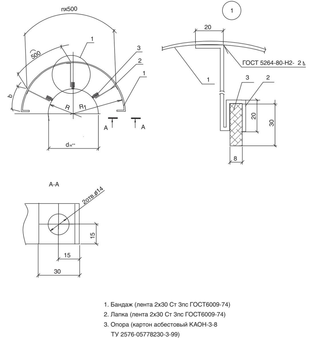
**Рисунок 72.** Элемент опорного кольца (для горизонтальных трубопроводов и аппаратов d<sub>н</sub> от 530 мм и более при толщине изоляции 100 мм и более)
