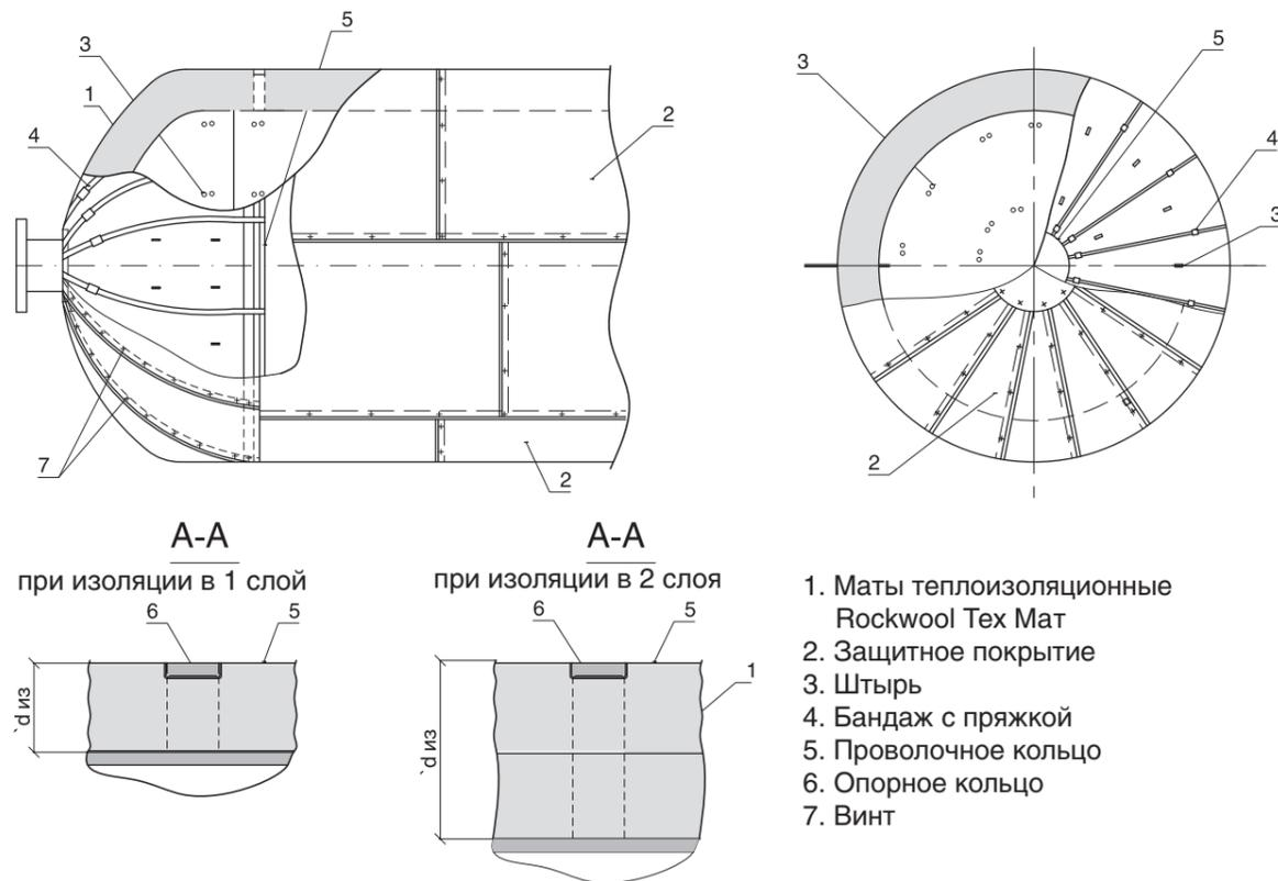
Рисунок 2.2.13. Изоляция днищ горизонтальных аппаратов теплоизоляционными матами Rockwool Tex Mat с креплением штырями и с металлическим защитным покрытием
