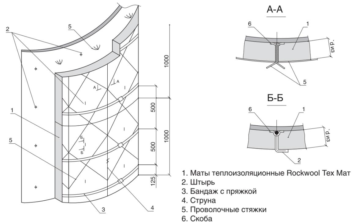
Рисунок 2.2.7. Изоляция вертикальных аппаратов теплоизоляционными матами Rockwool Tex Mat в один слой с креплением штырями и стяжками
