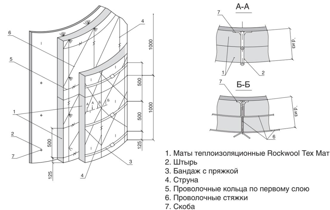
Рисунок 2.2.8. Изоляция вертикальных аппаратов теплоизоляционными матами Rockwool Tex Mat в два слоя с креплением штырями и стяжками
