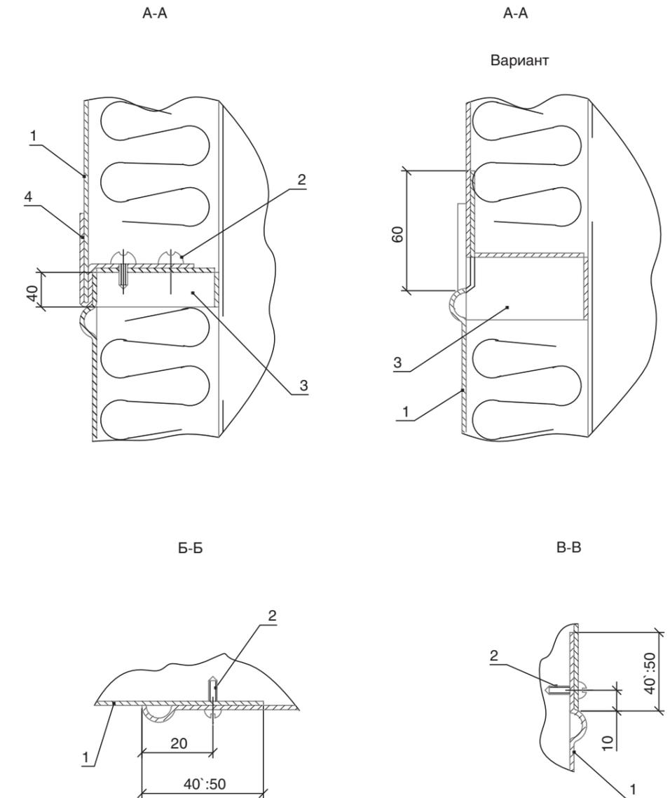
Сопряжение элементов покрытия из металлических листов
