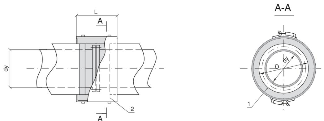
1. Матрац с теплоизоляционным слоем из матов теплоизоляционных Rockwool Tex Mat
