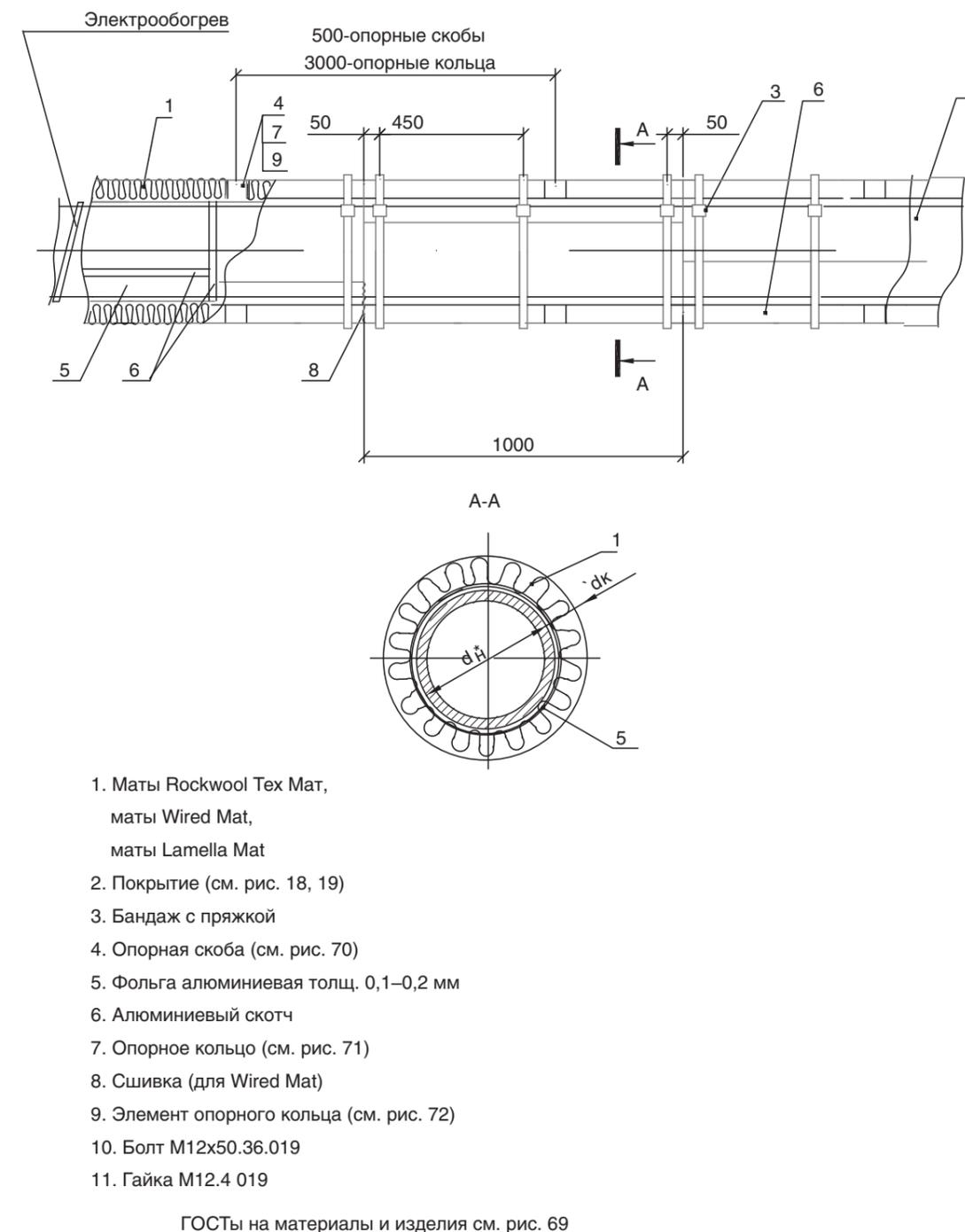
Рисунок 14. Изоляция горизонтальных трубопроводов с электрообогревом с наружным диаметром 219 мм и более матами Rockwool Tex Mat, Wired Mat, Lamella Mat в один слой с креплением бандажами
