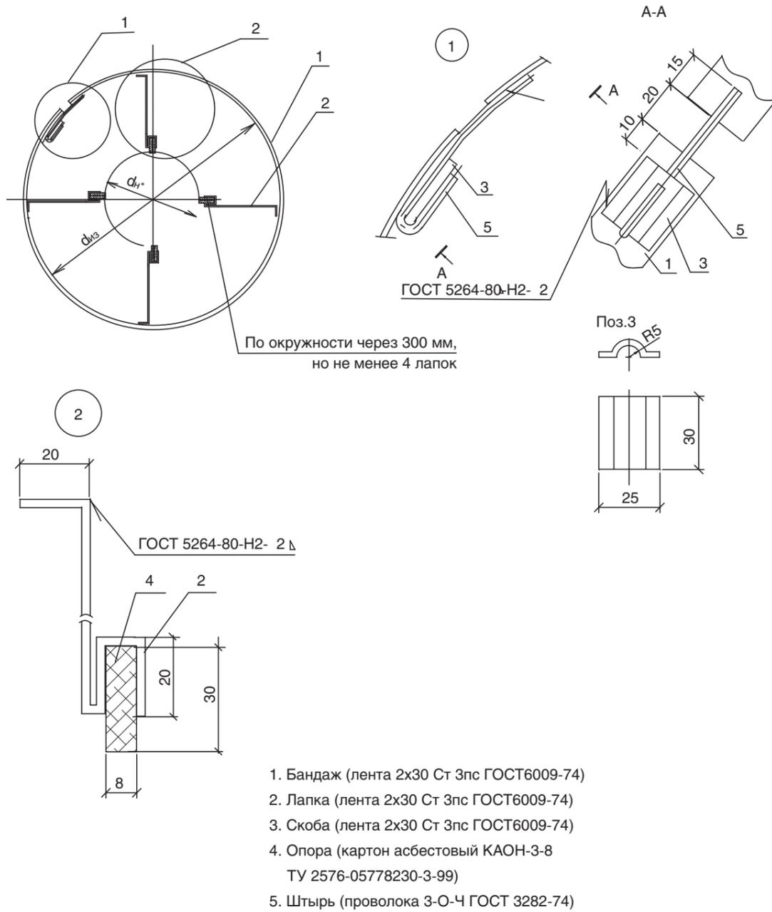
**Рисунок 71.** Кольцо опорное (для горизонтальных трубопроводов d<sub>н</sub> от 273 мм до 476 мм при толщине изоляции 100 мм и более)
