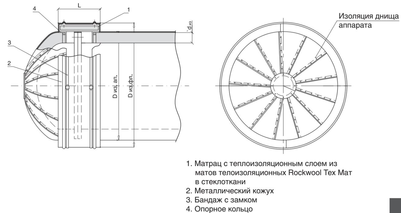
Рисунок 2.2.15. Изоляция фланцевого соединения горизонтального аппарата матрацами с теплоизоляционным слоем из теплоизоляционных матов Rockwool Tex Mat со съёмным защитным металлическим кожухом
