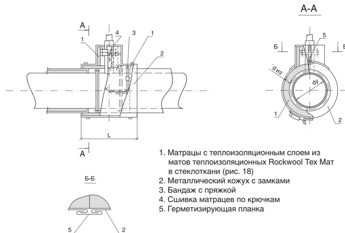
1. Матрацы с теплоизоляционным слоем из матов теплоизоляционных Rockwool Tex Mat в стеклоткани (рис. 18)
