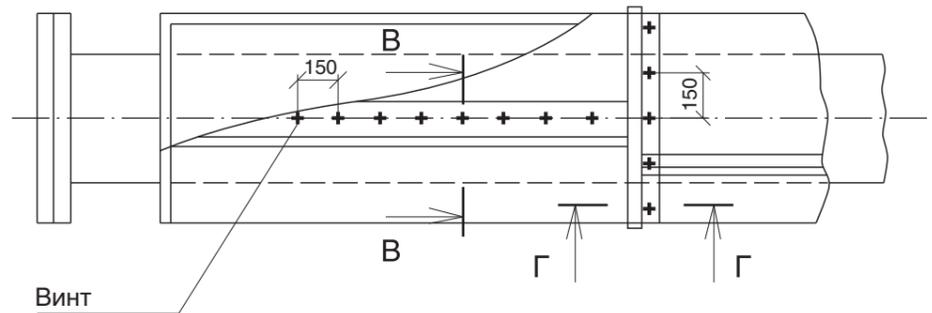
Рисунок 8. Изоляция цилиндрами. Крепление покрытия винтами
