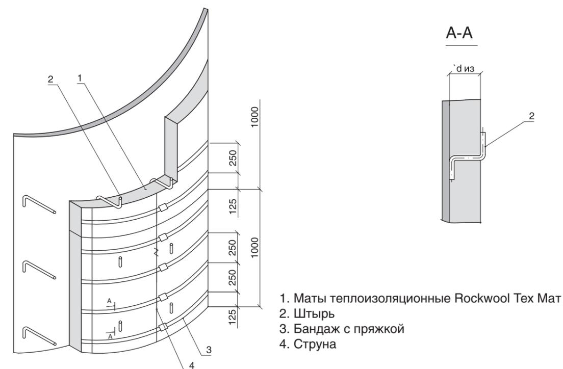
Рисунок 2.2.11. Изоляция вертикальных аппаратов теплоизоляционными матами Rockwool Tex Mat в один слой с креплением штырями
