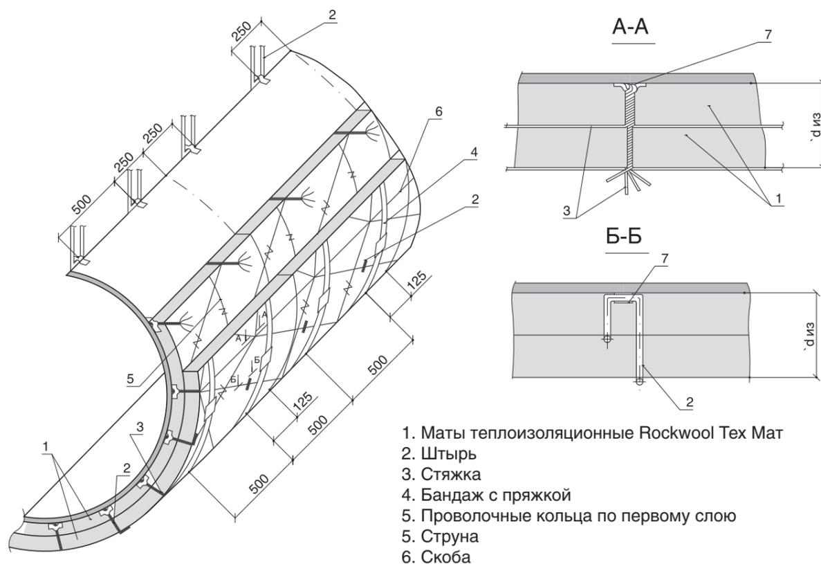
Рисунок 2.2.6. Изоляция горизонтальных аппаратов теплоизоляционными матами Rockwool Tex Mat в два слоя с креплением штырями и стяжками
