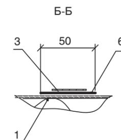
Рисунок 21. Изоляция трубопроводов с отрицательными температурами цилиндрами Ц-Кф, матами Rockwool Тех Мат-Кф, матами Lamella Mat с креплением металлического покрытия бандажами
