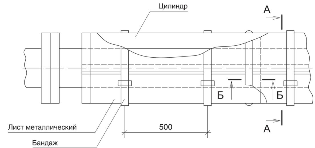
Рисунок 5. Тепловая изоляция трубопровода цилиндрами
