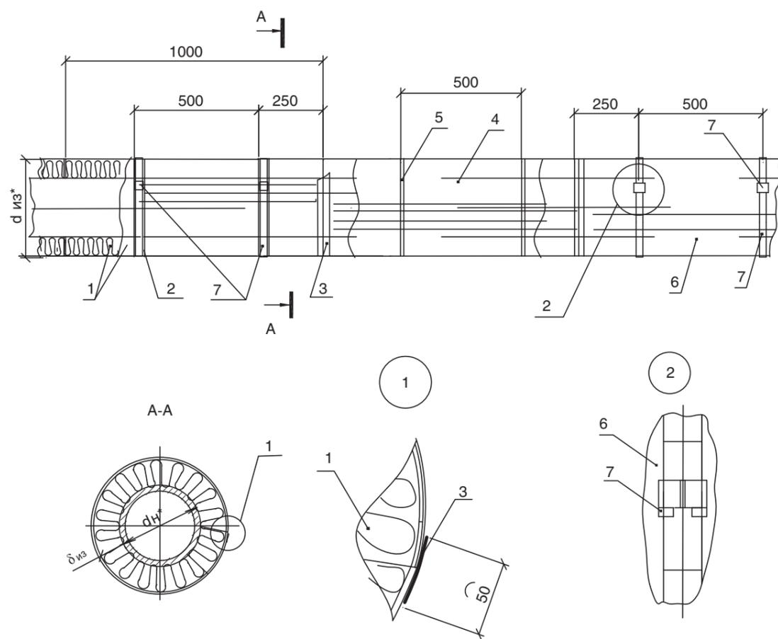
1. Цилиндры теплоизоляционные, кашированные фольгой
