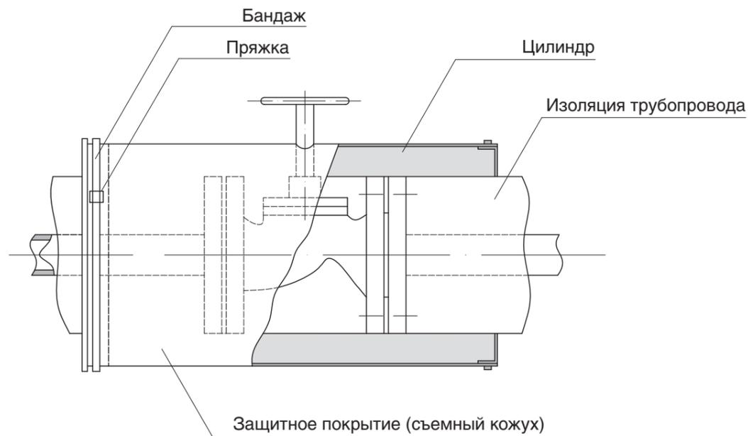
Рисунок 2. Тепловая изоляция арматуры фланцевой цилиндрами
