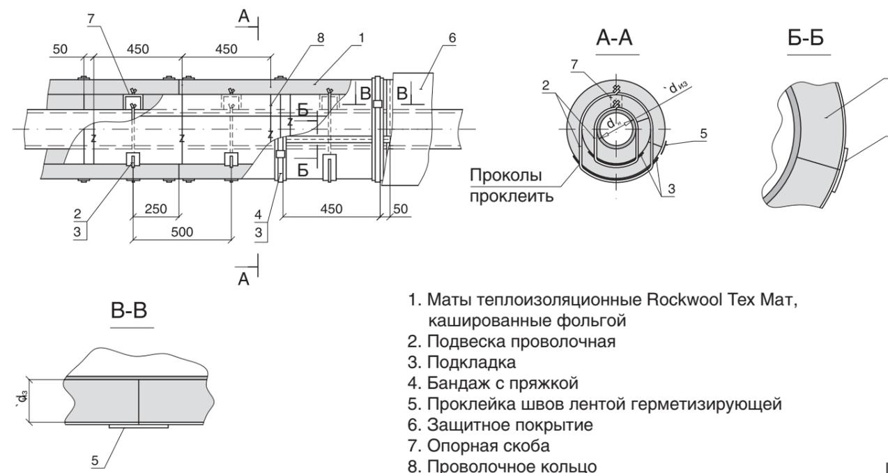
1. Маты теплоизоляционные Rockwool Tex Mat, кашированные фольгой
