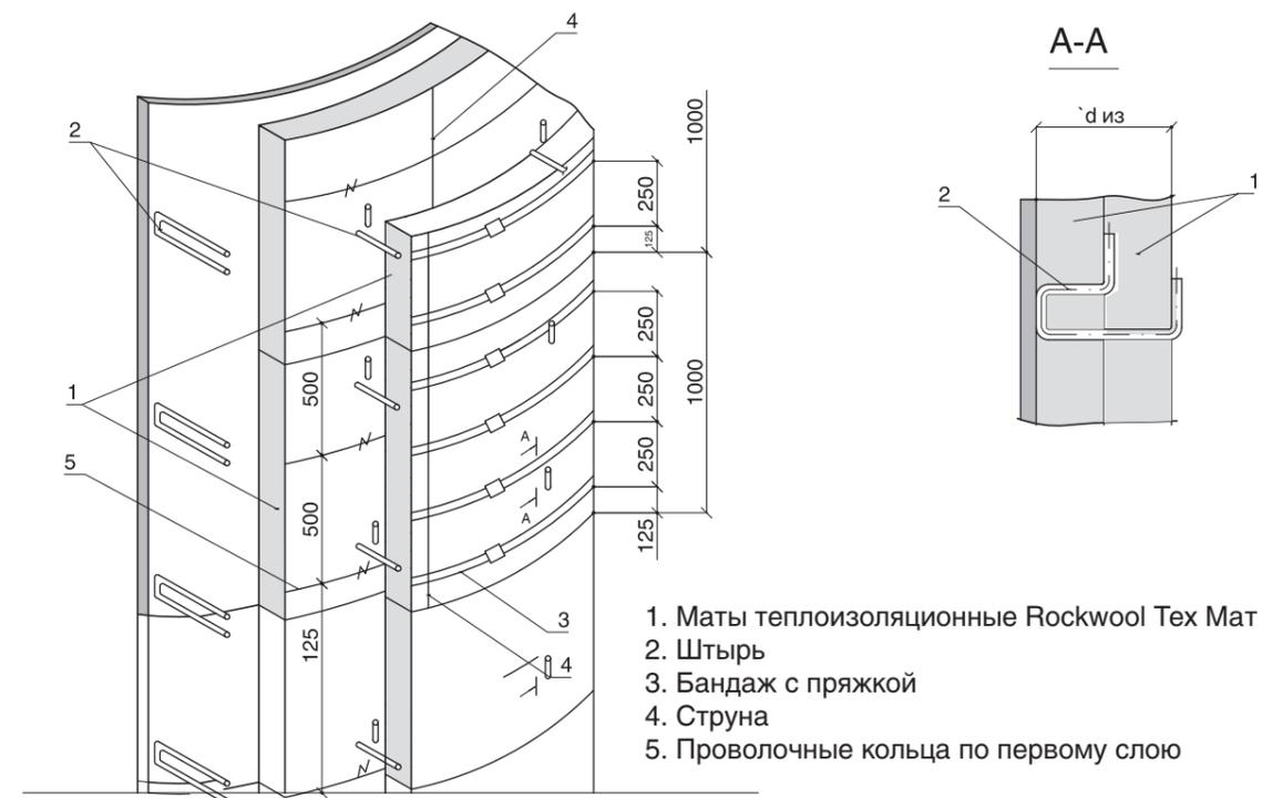
Рисунок 2.2.12. Изоляция вертикальных аппаратов теплоизоляционными матами Rockwool Tex Mat в два слоя с креплением штырями
