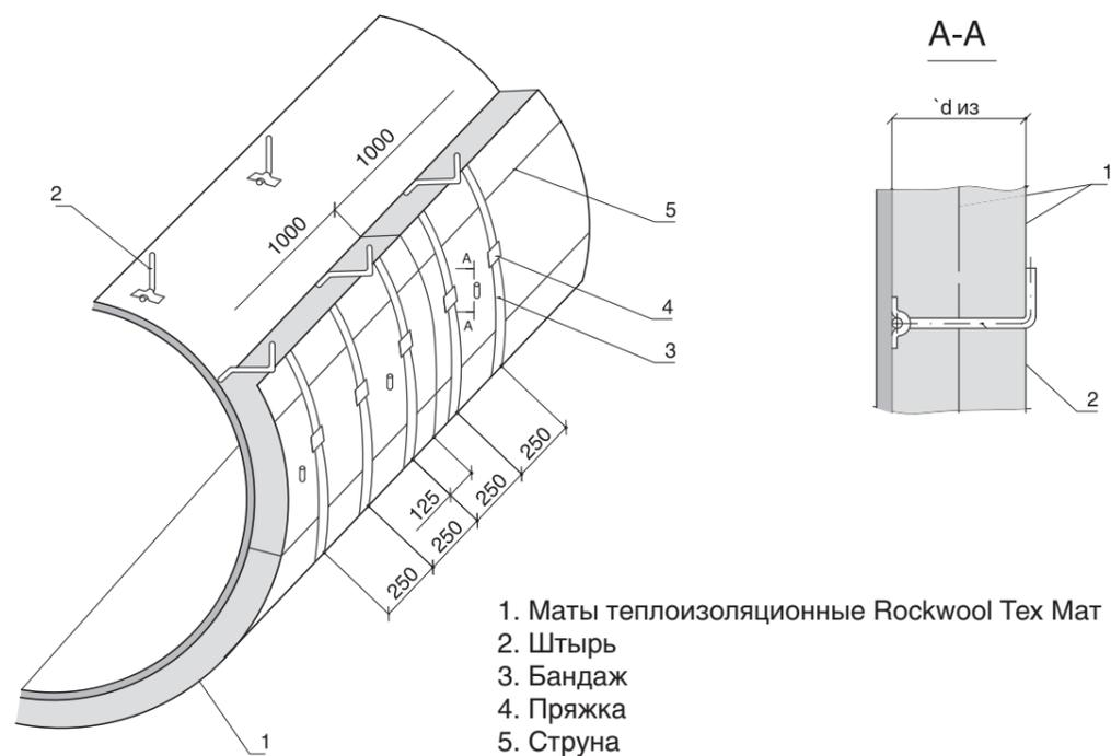
Рисунок 2.2.9. Изоляция горизонтальных аппаратов теплоизоляционными матами Rockwool Tex Mat в один слой с креплением штырями
