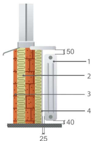
Рис. 1.15. Установка отопительного прибора:
