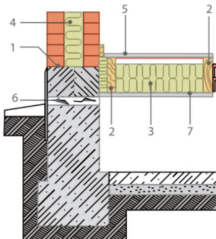
Рис. 4.1. Устройство продухов для вентиляции подполья:
