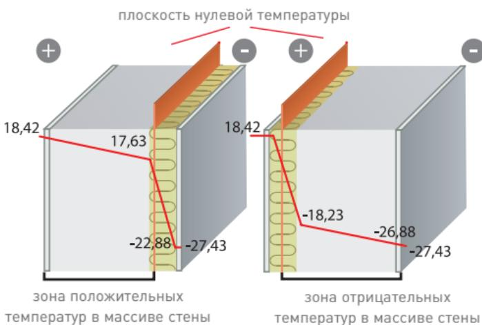
Рис. 1.2. Характер распределения температур в кирпичной стене толщиной 510 мм, утепленной плитами из каменной ваты толщиной 120 мм, при температуре внутреннего воздуха  $t_b = 20^\circ\text{C}$  и температуре наружного воздуха  $t_h = -28^\circ\text{C}$ .
