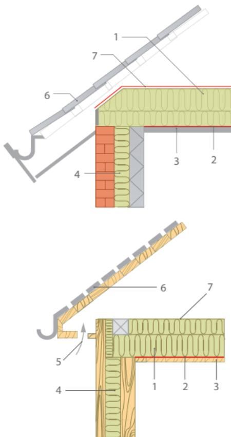
Рис 5.3. Чердачное перекрытие, утепленное плитами ROCKWOOL ЛАЙТ БАТТС®.
