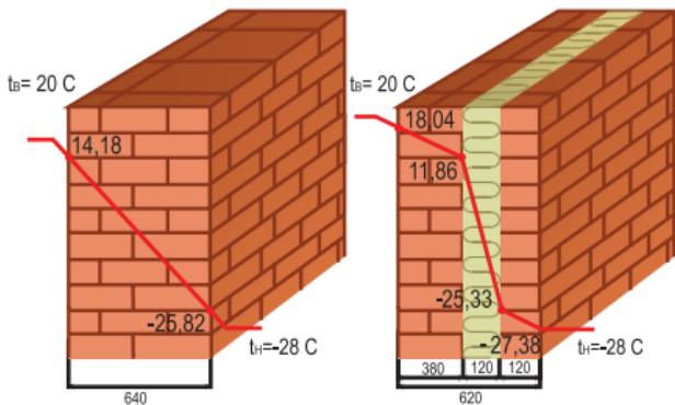
Рис. 1.1. Распределение температур в толще однослоиной и трехслойной стен.
