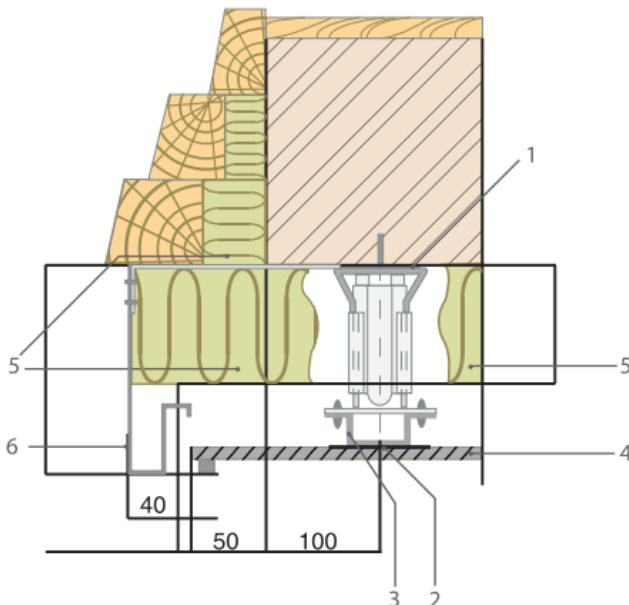
Рис. 1.26. Узел примыкания навесной фасадной системы
