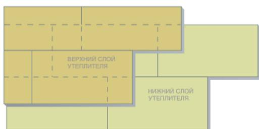
Рис. 6.14. Схема раскладки плит утеплителя
