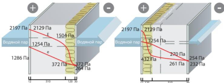
Рис. 1.3. Характер распределения упругости водяных паров в кирпичной стене толщиной 510 мм, утепленной плитами из каменной ваты толщиной 120 мм, при температуре внутреннего воздуха  $t_b = 20^\circ\text{C}$ , его относительной влажности  $j_b = 55\%$  и температуре наружного воздуха  $t_n = -28^\circ\text{C}$  и его относительной влажности 83%.
