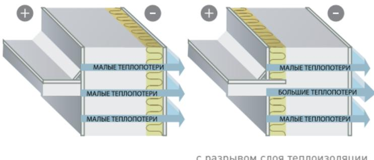
с разрывом слоя теплоизоляции
