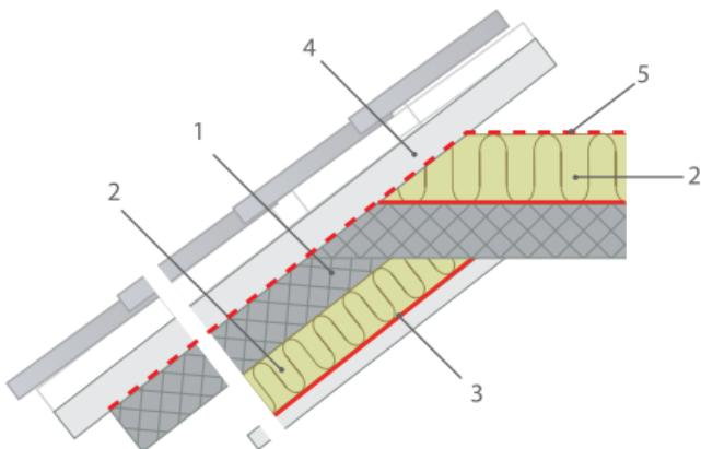
Рис. 6.7. Дополнительное утепление мансарды:
