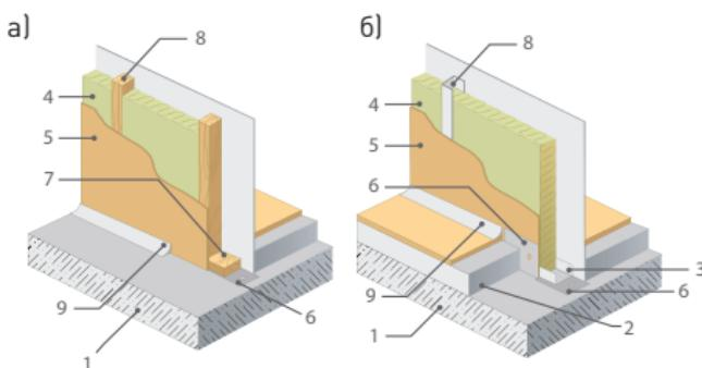
Рис. 2.1. Каркасно-обшивные перегородки с деревянным (а)
