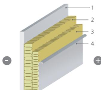
1 — наружный слой; 2 — пористый паропроницаемый слой; 3 — плотный паронепроницаемый слой; 4 — пароизоляция.
