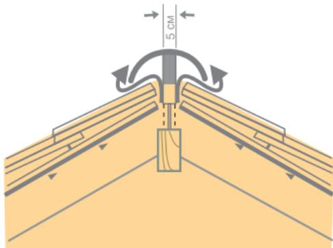
Рис. 6.4. Схема устройства коньковых продухов
