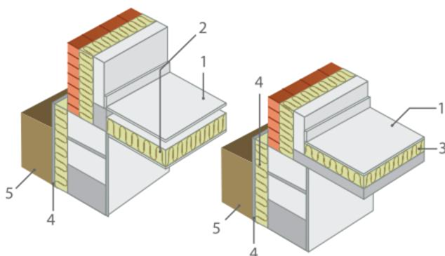
Рис. 4.8. Утепление стен теплых подвалов:
