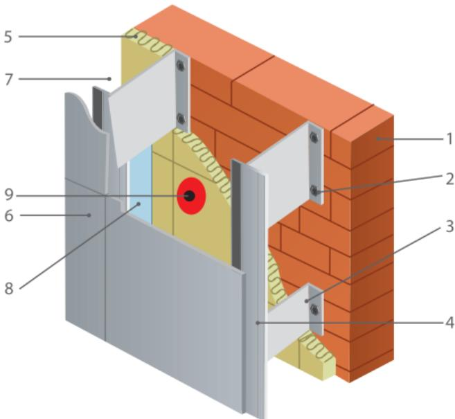
Рис. 1.25. Конструкция навесного фасада с воздушным зазором:
