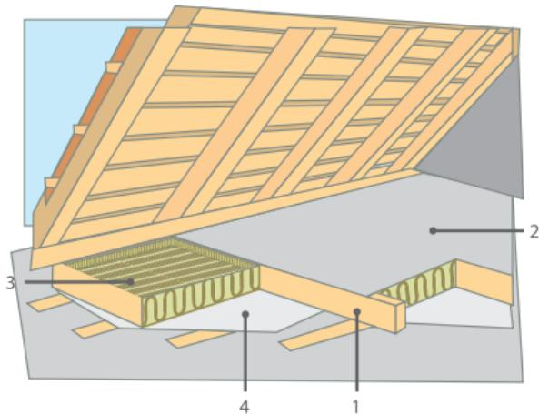
Рис 5.1. Чердачное перекрытие, утепленное плитами ROCKWOOL ЛАЙТ БАТТС®:
