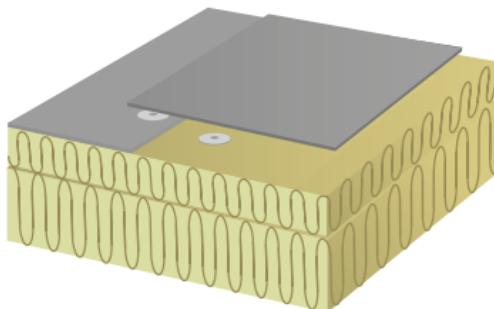
Рис. 6.15. Крепление гидроизоляционной мембраны к покрытию
