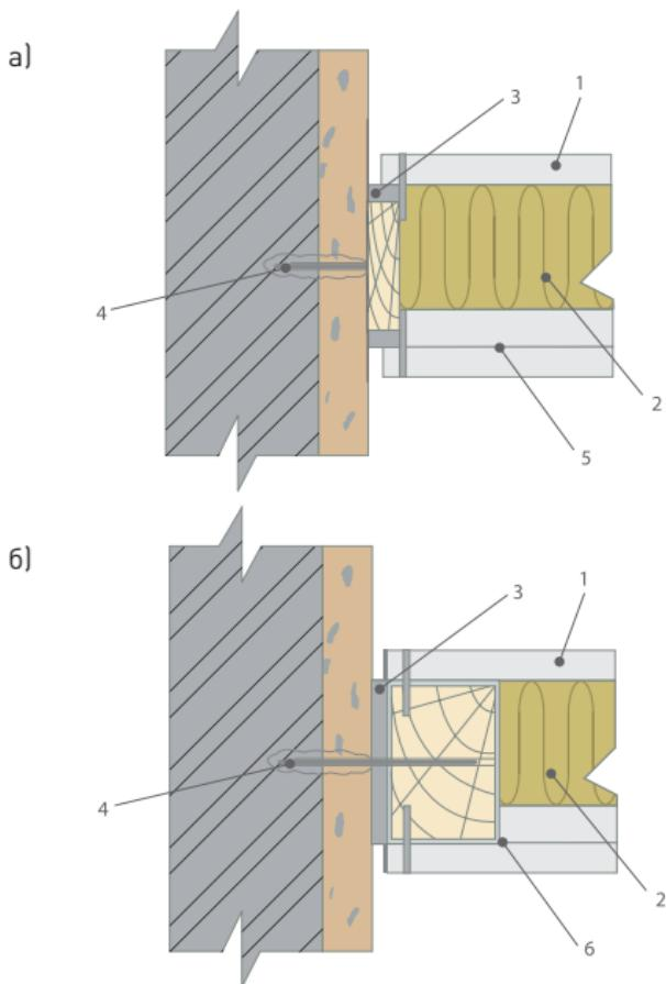
Рис. 2.4. Примыкание каркасно-обшивочных перегородок к стенам
