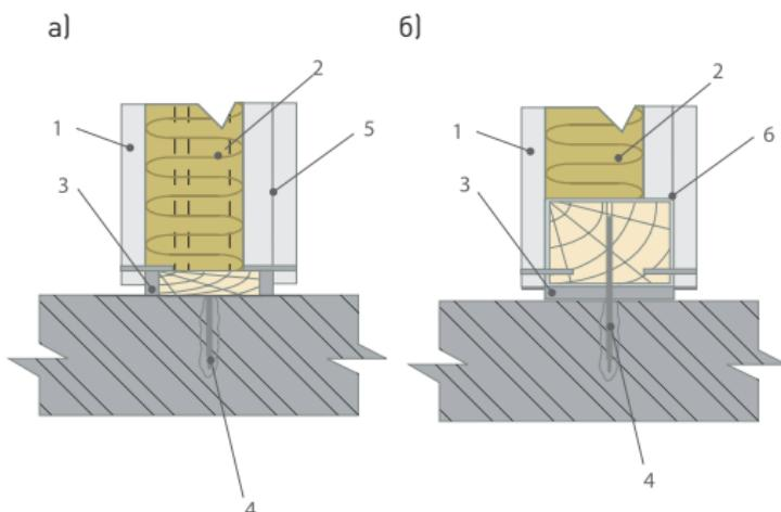
Рис. 2.3. Опорение перегородок на междуэтажное перекрытие:
