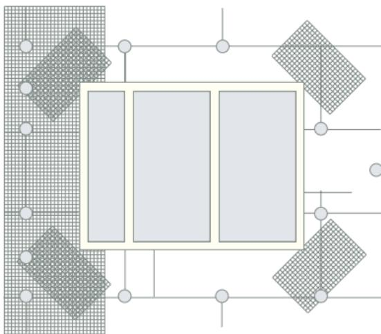
Рис. 1.21. Раскладка утеплителя с перевязкой шов, устройство технологических вырезов в плитах утеплителя около проемов, установка дополнительных косынок из стеклосетки.
