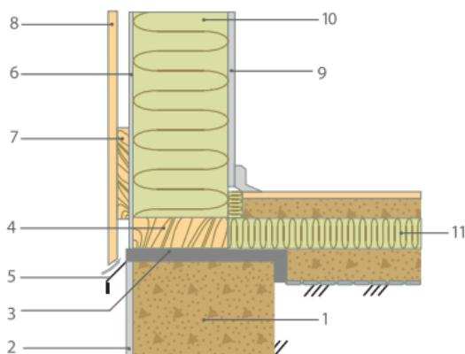
Рис. 1.7. Устройство горизонтальной гидроизоляции каркасно-обшивочных стен:
