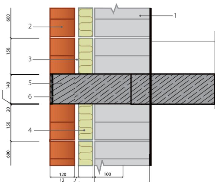
Рис. 1.19 Устройство несущих поясов в защитно-декоративной
