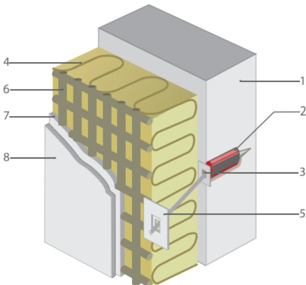
Рис. 1.23. Система наружного утепления с толстым штукатурным слоем
