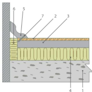
Рис. 3.3. Примыкание полов к стенам и перегородкам:
