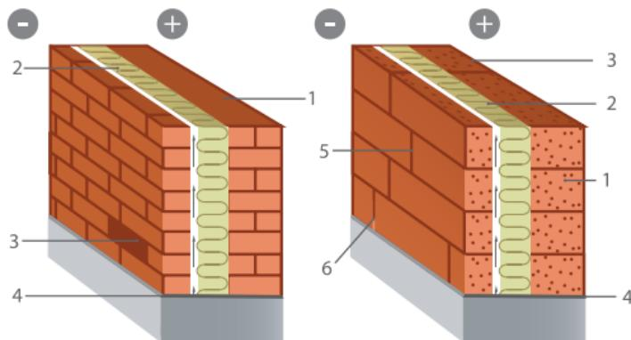
Рис. 1.9. Устройство вентиляционных продухов в кирпичной стенке:
