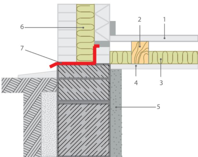
Рис. 4.9. Утепление стен теплого подвала изнутри:
