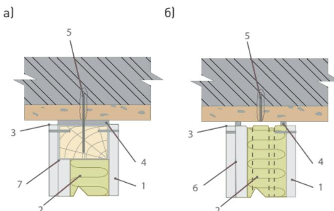
Рис. 2.2. Примыкание перегородок к верхнему перекрытию:
