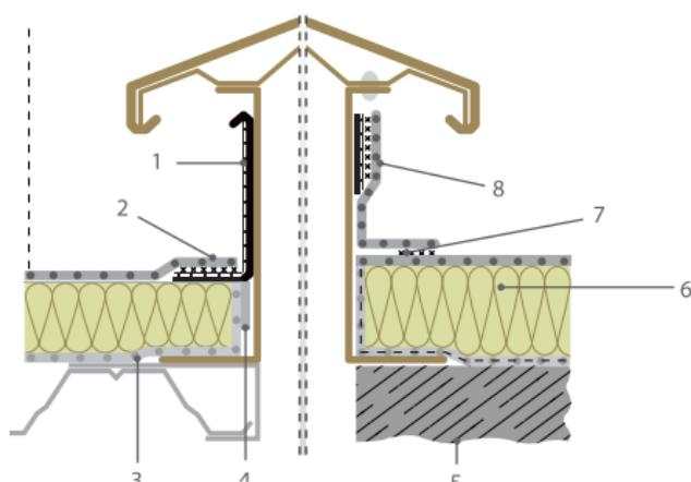
Рис. 6.13. Примыкание пароизоляции ROCKbarrier к гидроизоляционной мембране ROCKmembrane к выступающим элементам на покрытии.
