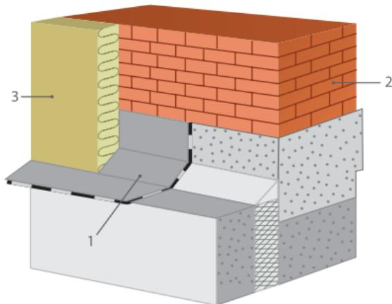
Рис. 1.11. Устройство гидроизоляционного слоя:
