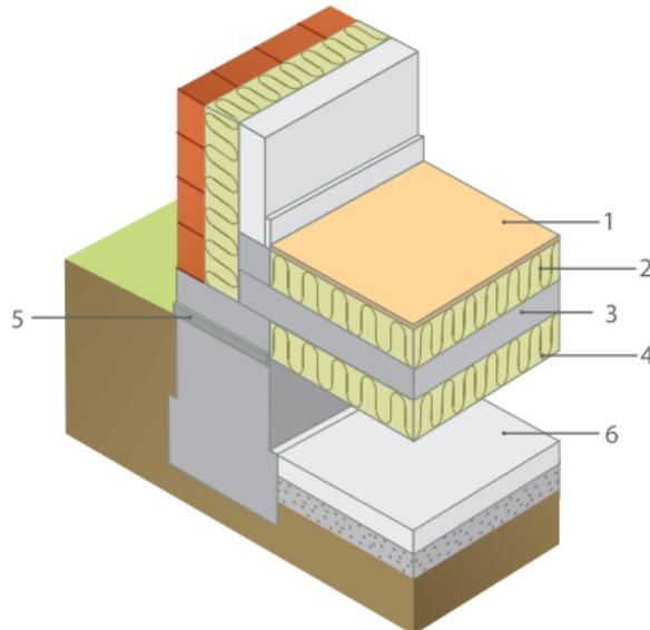
Рис. 4.6. Дополнительное утепление перекрытия над подвалом:
