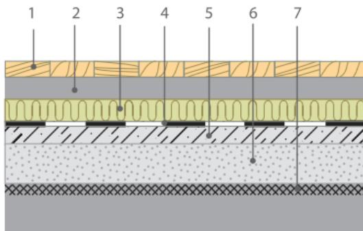
Рис. 4.10. Утепление пола по грунту:
