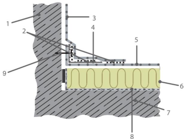
Рис. 6.17. Примыкание системы ROCKROOF к вертикальной стене и водосточной воронке
