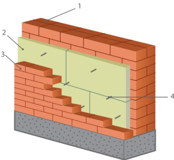
Рис. 1.12. Установка плит ROCKWOOL КАВИТИ БАТТС® в трехслойной кирпичной стене:
