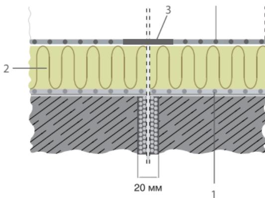
Рис. 6.16. Изоляция деформационного шва
