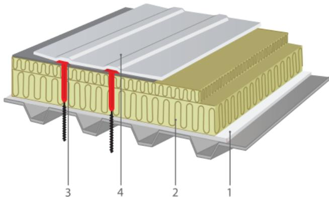
Рис. 6.12. Компоненты системы ROCKROOF:
