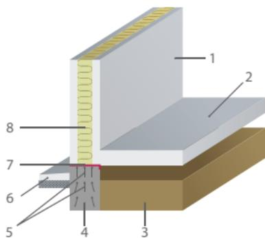
1 — стена; 2 — плита перекрытия; 3 — грунт;
