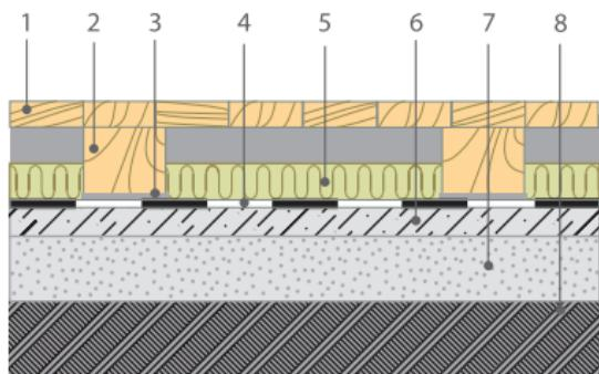
Рис. 4.11. Утепление пола по грунту:
