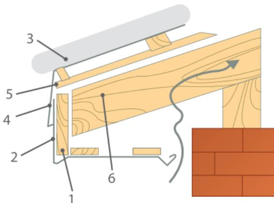
Рис. 6.5. Устройство продухов в подшивке карниза:
