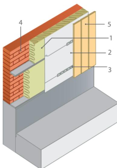
Рис. 1.8. Устройство вентилируемой воздушной прослойки в стенах с обшивкой сайдингом:
