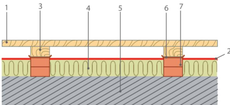
Рис. 4.5. Утепление плитного перекрытия с лагами по столбикам:
