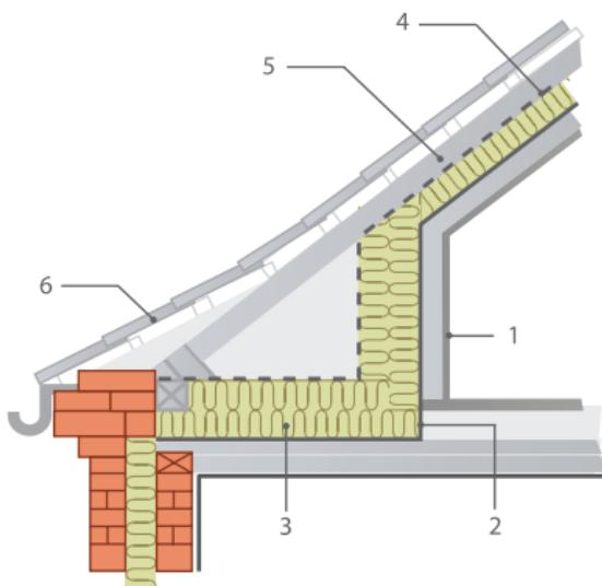
Рис. 6.6. Установка изоляционного материала по всей поверхности конструкций, граничащих с наружной средой:
