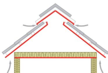
Рис. 5.4. Расположение вентиляционных продухов на чердаке.
