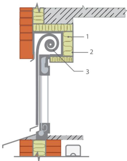
Рис. 1.14. Утепление полости для свернутых роль-ставней:
